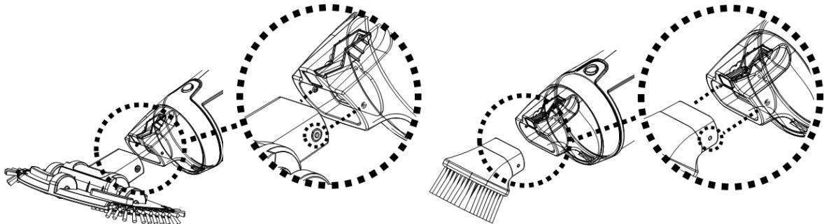
NOTE : Pour remplacer les brosses sur la tête d'aspiration, soulever l'extrémité et la pousser dehors pour laisser un espace pour une nouvelle.
