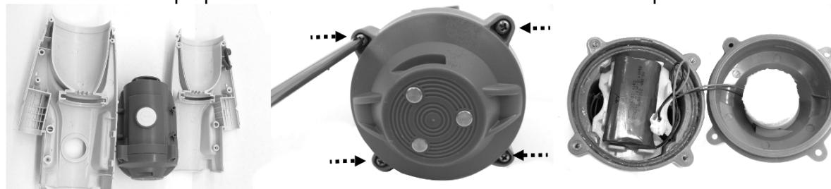
4. Retirer le pack de batterie du compartiment principal. Pour détacher le pack de batterie, appuyer sur le clip du connecteur et tirer le fil. NOTICE: Emballer immédiatement le connecteur avec de l'isolant afin d'éviter un court circuit si les deux bouts de fils se touchent.
