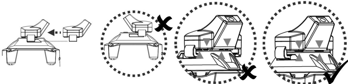
2. Conecte la parte hembra del adaptador externo dentro el orificio de carga localizada en la base del cargador.
