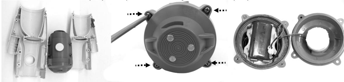
4. Quitar el paquete de batería de la cámara principal. Para quitar el paquete de batería, apreté el clip del conector y dispáralo. NOTA: Envuelva inmediatamente el conector con cinta aislante para evitar cortocircuitos causados por el contacto de los dos polos del cable.
