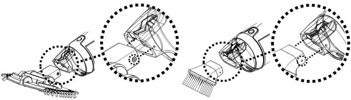
**NOTA:** Para sustituir los cepillos del cabezal de succión, levante el extremo y tire de él para dejar espacio para uno nuevo.
